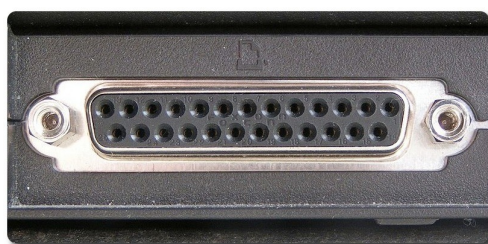
Párhuzamos nyomtatóport aljzata
